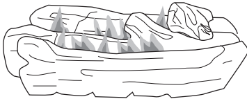
Figura 45 - Patrón correcto de la llama del quemador
