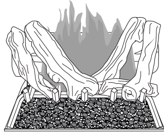
Figure 40 - Apparence de flammes typique
